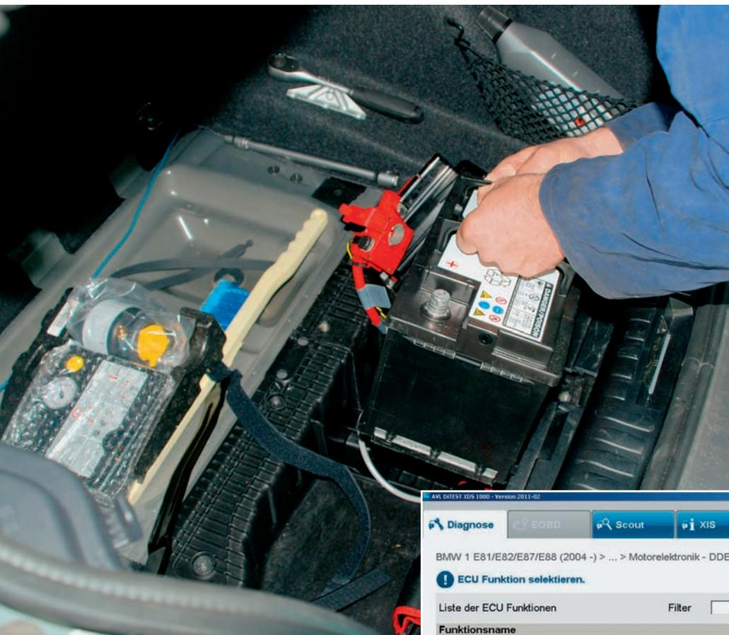
**Registrieren von Vorteil:** Bei der in Fahrzeugen mit Energiemanagement vorzunehmenden Anmeldung der neuen Batterie – wenn vom Fahrzeughersteller vorgesehen (Kreis) – wird der Kilometerstand erfasst und Lernwerte zur alten Batterie (zum Beispiel Startanzahl, Spannung, Ladestrom) zurückgesetzt. Bilder: Schmidt
